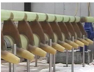
傳統噴流曝氣與氣液混合流況
